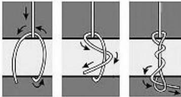
La siguiente imagen representa la parte inferior de la guitarra, llamada puente. Fija el final de la cuerda al puente y cruza varias veces la cuerda, para que no haya deslizamiento.
